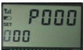
(2)按 ENT 键到需要更改的参数项, 按 DN 键移动光标到要更改的数字处, 然后 UP 按键更改参数设置, 设置完后需要再次按下 ENT 键保存该设置, 仪表保存该参数后自动跳到下一项参数, 若不需要继续修改参数值, 同时按下 DN ENT 键退出参数设定界面。设定完后, 按下 PWR 按键, 设备会复位重启, 参数设置完成。
