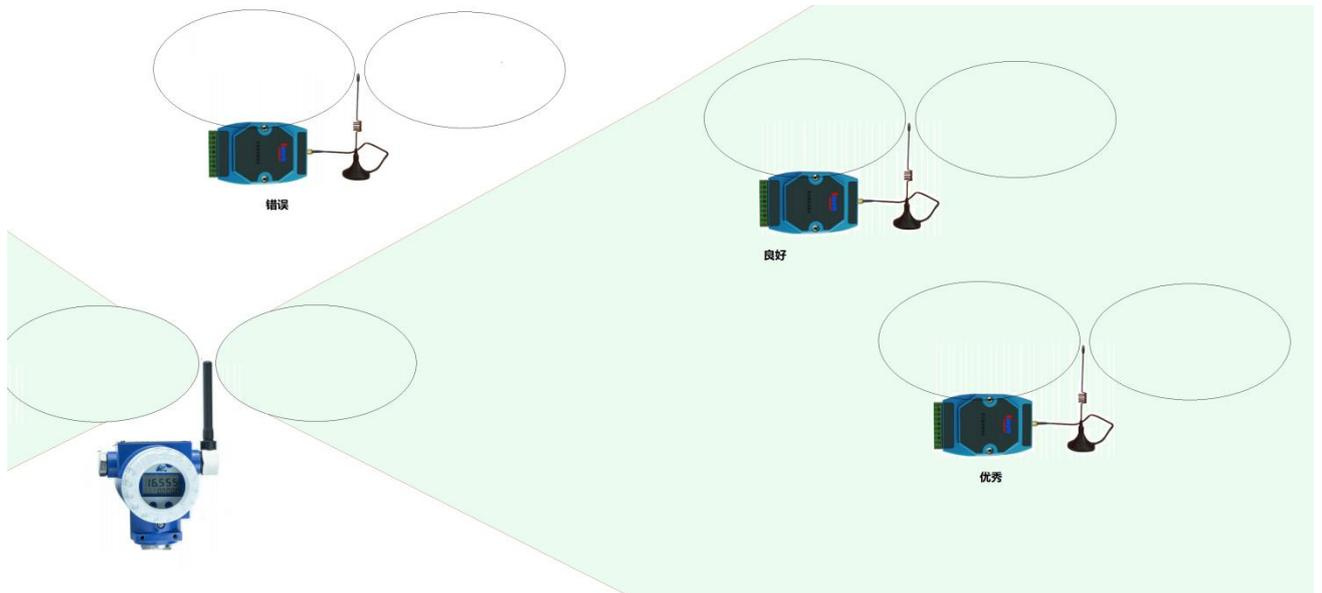
(6) 天线的定位需要远离金属物体，当距离大于 30 厘米，金属物体的影响变得较弱，无线设备安装时离开建筑物、金属设备一定距离(建议 0.5-1 米)。
