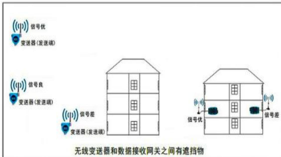
注：吸盘天线应竖直向上安装，高度越高越好。如天线安装在墙边铁皮建筑边（如上图）等，应离墙面大于20cm。
