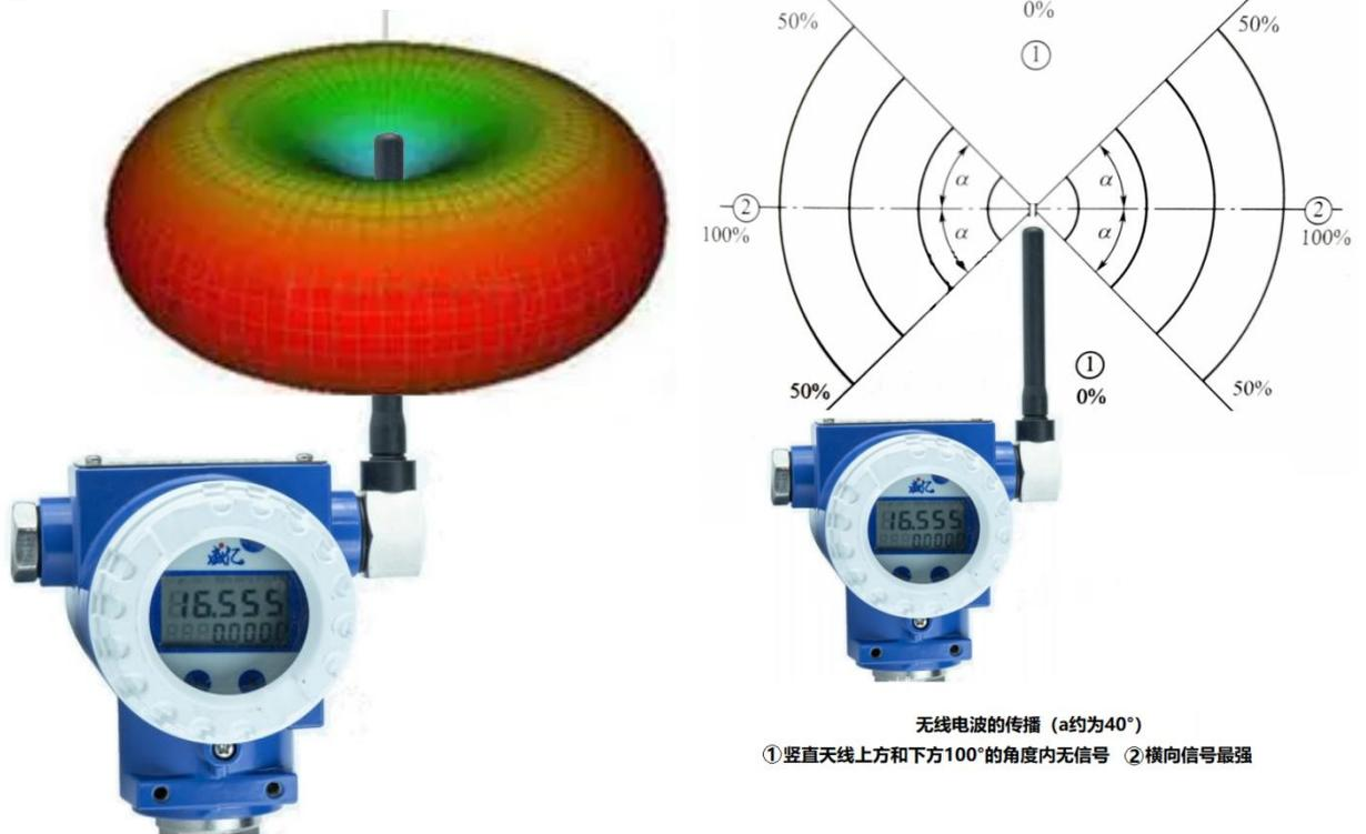
无线电信号的传播,波的扩散犹如一个甜甜圈,天线的顶部方向和下部方向 100° 范围内基本上没有信号
