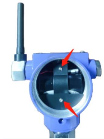
3 取下电池包上面的 2 芯供电插头，将新买的电池换上插上 2 芯供电插头即可。
